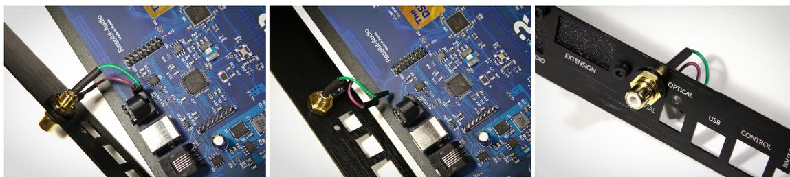
**Шаг 3.** Установите модуль Resolut USB-IN HQ как это показано на фотографии. Проследите за тем, чтобы разъёмы на модуле точно совпали с соответствующими пинами на плате процессора.
