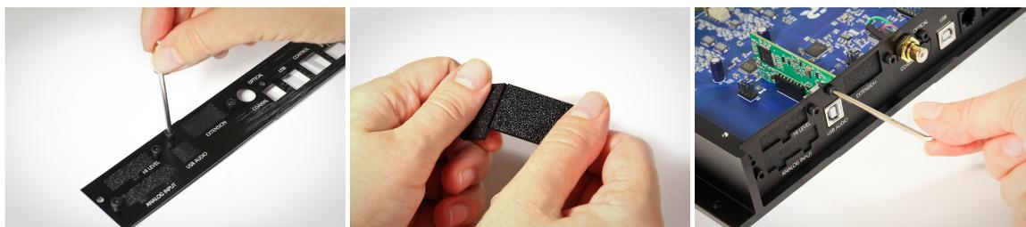
**Совет.** Сохраните базовую панель и заглушки, снятые со сменной панели. Если со временем возникнет необходимость изменить конфигурацию процессора установкой/удалением опциональных модулей, вы можете вернуть заглушки на свои места или снова установить базовую панель.
