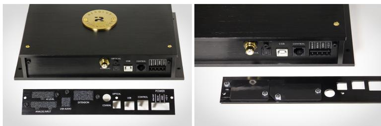
**Шаг 2.** Аккуратно отсоедините от платы разъём цифрового коаксиального входа. Запомните, в каком порядке провода идут от него к плате, в последующем их нужно будет подключить обратно. Открутите разъём с базовой панели и переставьте его на новую сменную панель.
